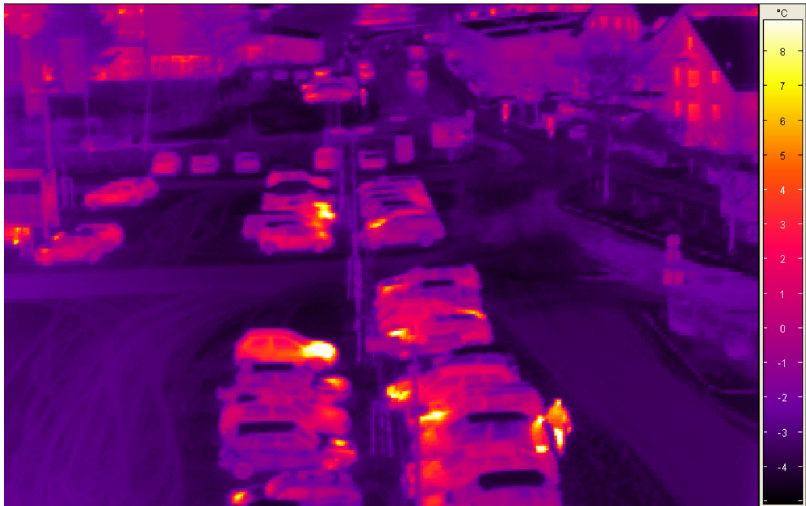
Abb. 7: Bildaufnahme im FIR (Wärmebild), Falschfarben-Darstellung (Glühfarben)
