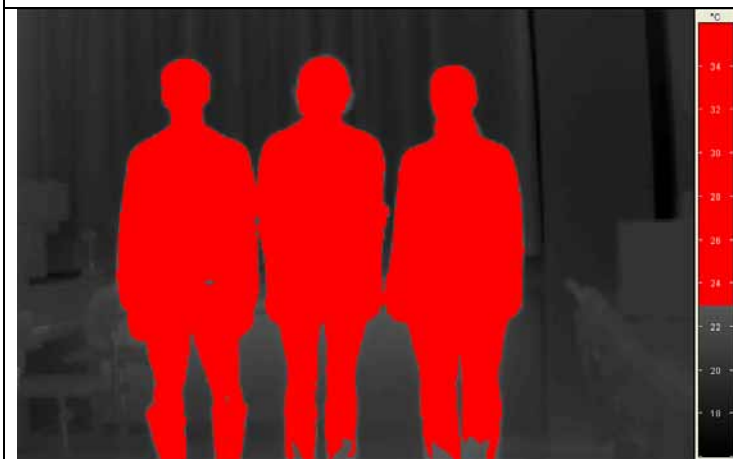
Abb. 6: Bildaufnahme im MIR (Wärmebild) Darstellung: Schwarz-Weiß-Bild mit Isothermenbereich
