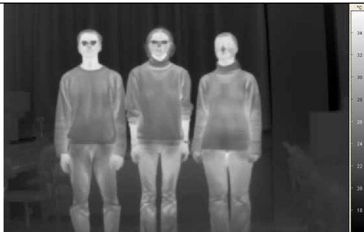
Abb. 3: Bildaufnahme im MIR (Wärmebild) Darstellung als Schwarz-Weiß-Bild
