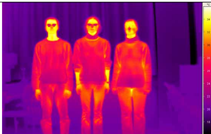
Abb. 4: Bildaufnahme im MIR (Wärmebild) Darstellung als Glühfarbenskala
