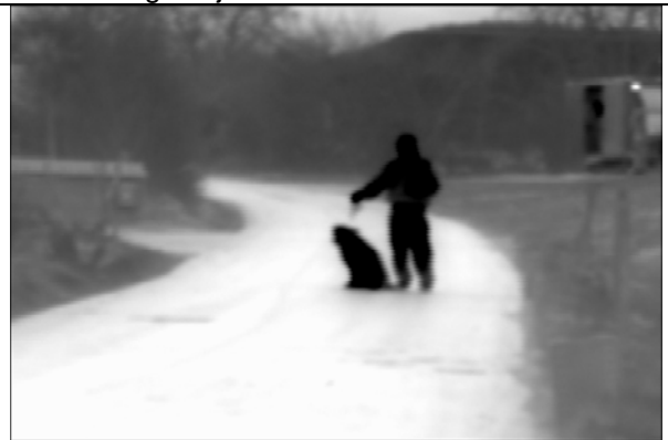
Abb.5: MIR-Bild (Wärmestrahlungsbild), Objekt 50m entfernt, schwarz = warm, weiß= kalt, Anmerkung: Objekt dunkel
