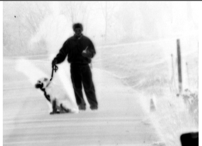
Abb. 3: NIR-Bild mit Scheinwerfer, Objekt 50m entfernt, schwarz = hohe Reflexion, Anmerkung: Objekt dunkel
