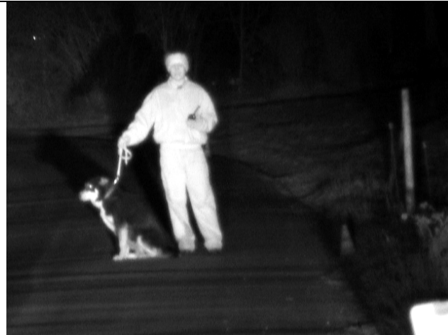
Abb. 2: NIR-Bild mit Scheinwerfer, Objekt 50m entfernt, weiß = hohe Reflexion, Anmerkung: Objekt hell
