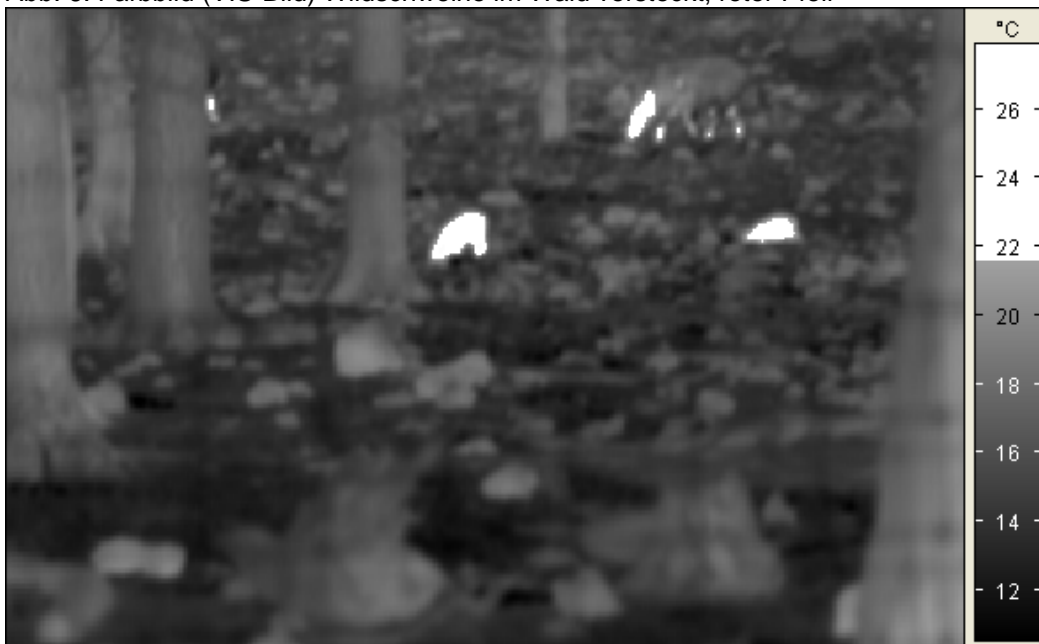
Abb. 7: Wärmestrahlungs-Bild, Wildschweine mit Frischlingen, Schwelle für Weiß: 21,5°C Die Tiere sind auf dem Wärmebild sehr gut als weiße Flächen zu erkennen.
