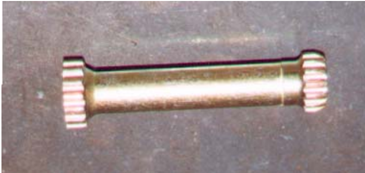
Abbildung 1: Der Torsionsstab hat einen Durchmesser von 9,5mm in der Mitte und eine Länge von 70mm.
